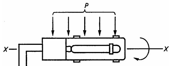
Наибольшая площадь проекции светильника в данном примере - это вид сбоку.
