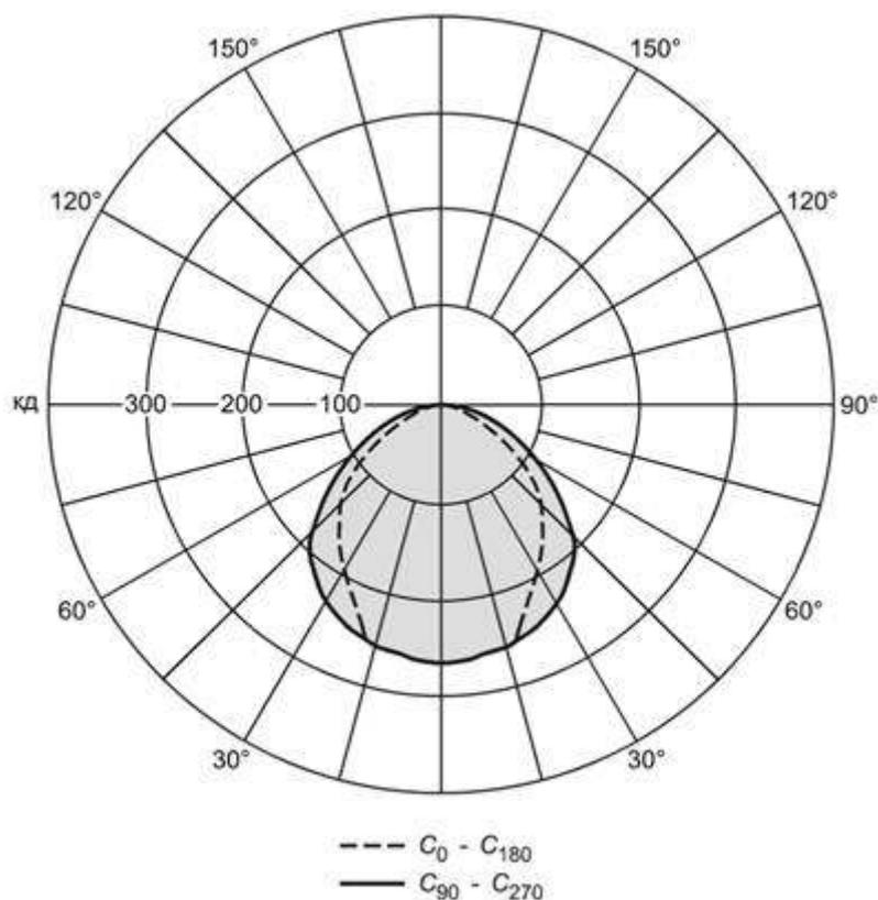
Рисунок В.1 - Кривая силы света светильника с симметричным светораспределением
